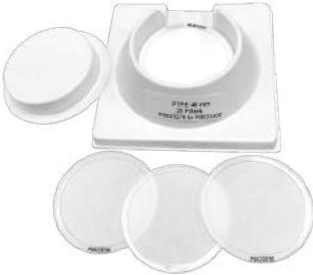
La membrana de PTFE PM 2.5 de GVS es una membrana fina de gran pureza para el control ambiental del aire PM 2.5. Cada membrana está numerada secuencialmente con un anillo de soporte de polipropileno químicamente resistente. La baja masa tarada permite determinaciones gravimétricas precisas. No se utilizan pegamentos ni adhesivos para la fabricación de las membranas y su diseño estable elimina la ondulación, lo que mantiene la membrana plana y la hace apta para uso en robots.
