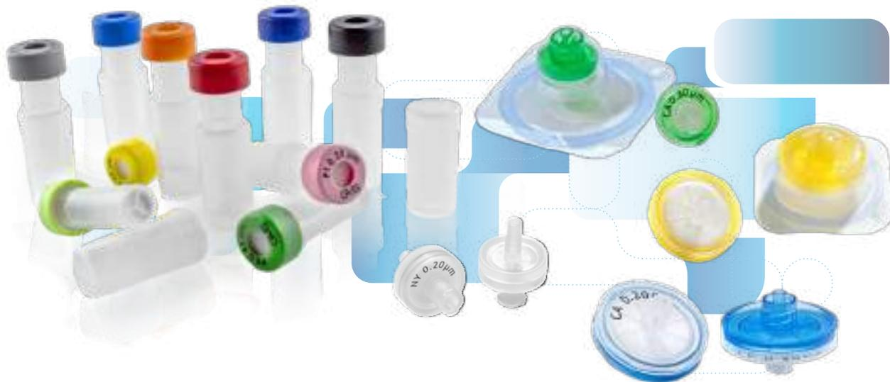
GVS ofrece una línea completa de dispositivos utilizados en laboratorios de química y biología para la filtración: filtros de jeringa, viales de filtro sin jeringa, cápsulas de filtración, filtros centrífugos y filtros para frascos, así como una completa oferta de dispositivos complementarios.
